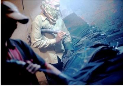
Für einen „used look“ werden die Jeans (z.B.) mit Sandstrahlen bearbeitet. Dieser Vorgang ist sehr gesundheitsschädlich für die Arbeiter: Der Sandstaub verursacht **Silikose**, eine Lungenkrankheit, die in schweren Fällen zum Erstickten führt.<sup>28</sup>
